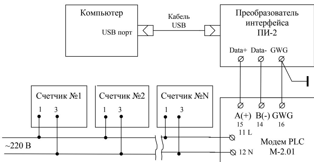
Рисунок В.2- Схема подключения счетчиков к компьютеру через PLC-модем M-2.01
