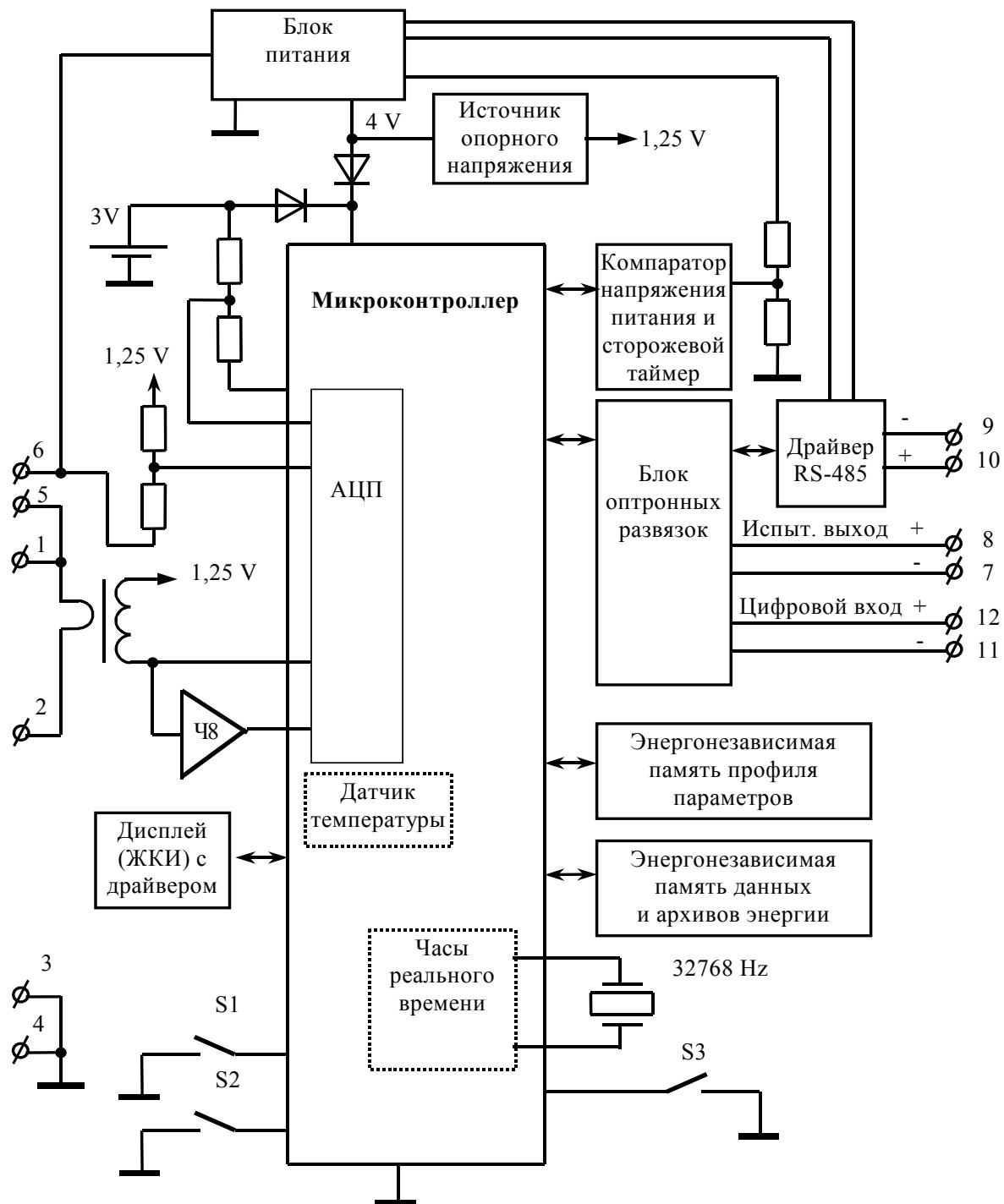
Рисунок 2- Структурная схема счётчика СЭБ-1ТМ.02Д с интерфейсом RS-485
