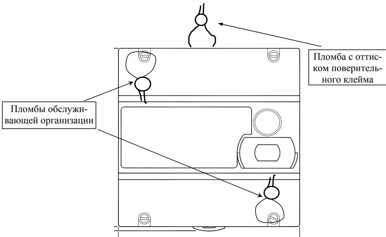
Рисунок 4— Пломбирование счётчика
