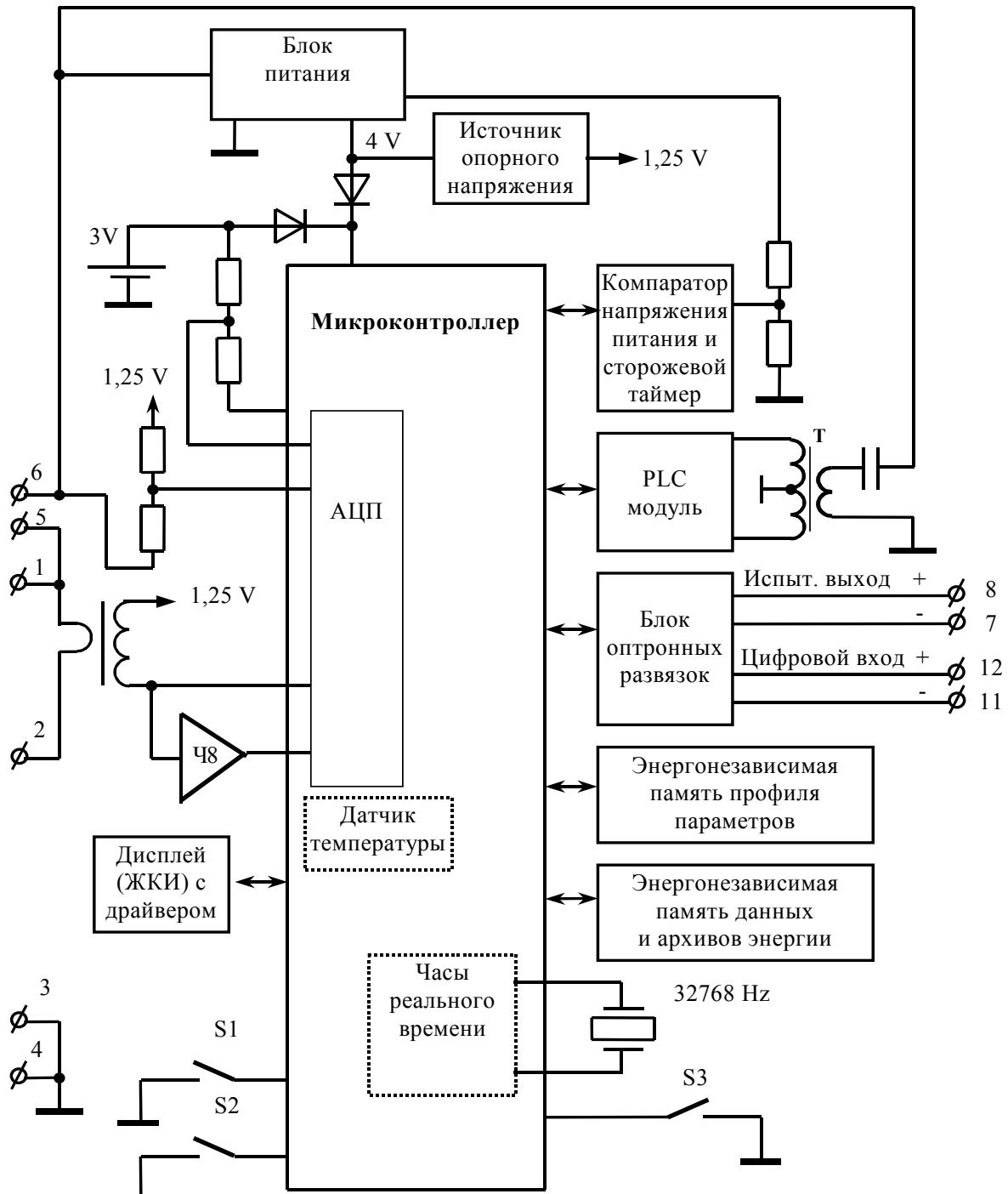
Рисунок 3 - Структурная схема счётчика СЭБ-1ТМ.02Д с PLC-модемом
