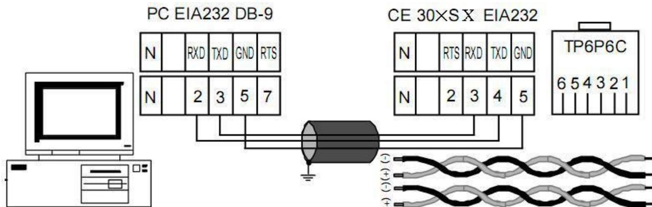
Примечание – Вилка TP6P6C – используется в счетчике с интерфейсами EIA232 и EIA485.
