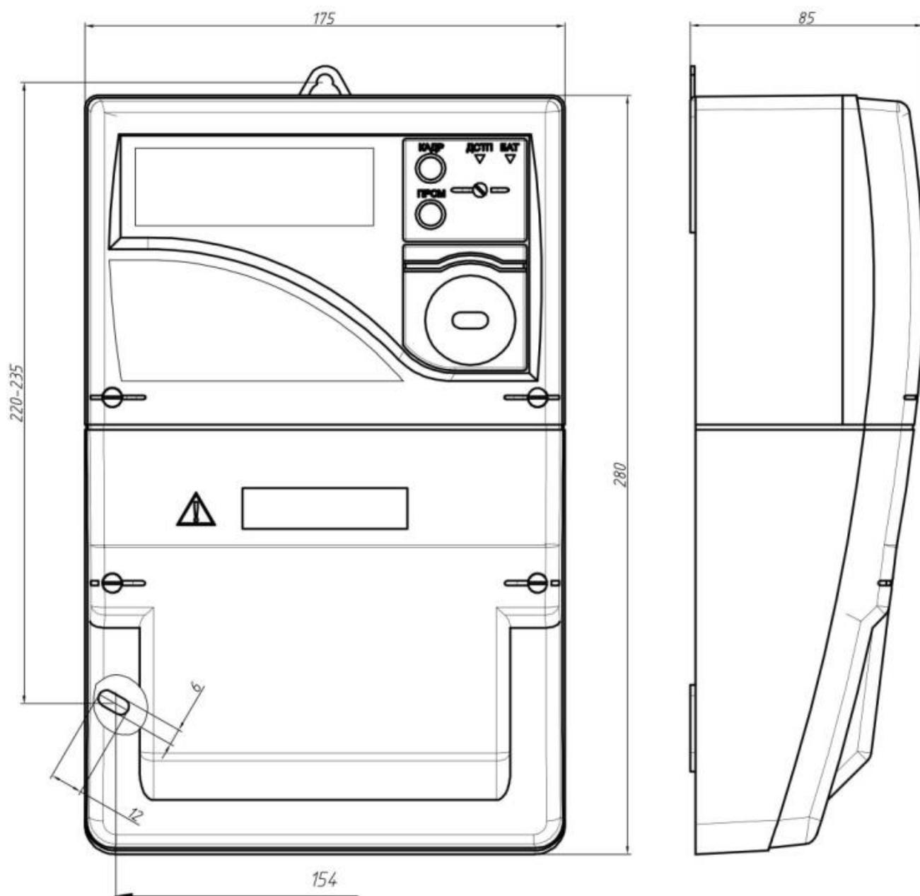
Общий вид счетчика СЕ30х R33 (с укороченной клеммной крышкой)
