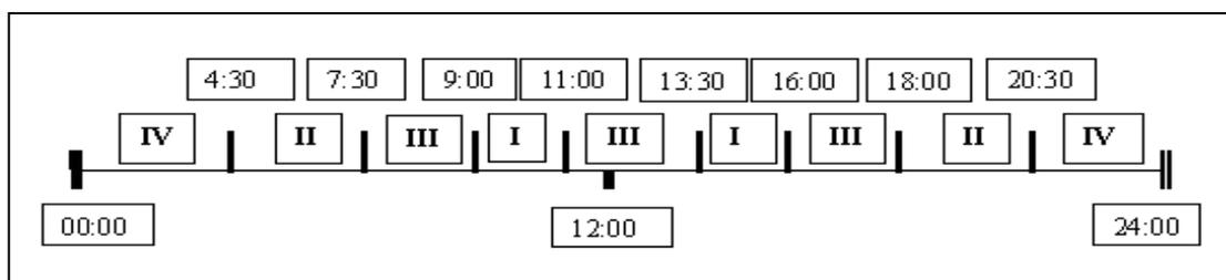
Рисунок 7.8 – Пример построения суточного расписания переключения тарифов
