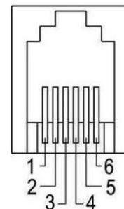
б) обозначение контактов розетки "19" (для исполнений счетчиков с интерфейсами EIA485, EIA232, СЕ831М0х.03)
