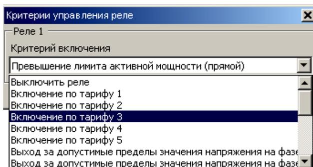
Рисунок 7.23 – Окно редактирования параметра группы «Критерии управления реле»
