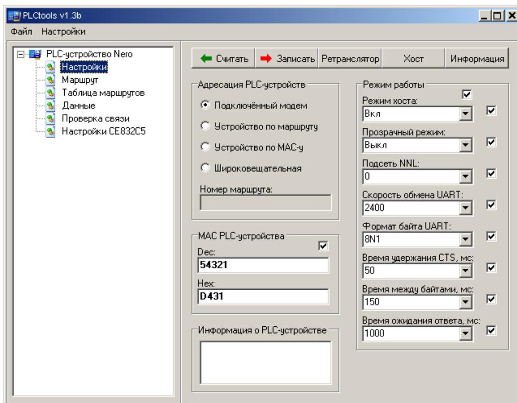
Рисунок 5.22 – Настройки PLC-модема
