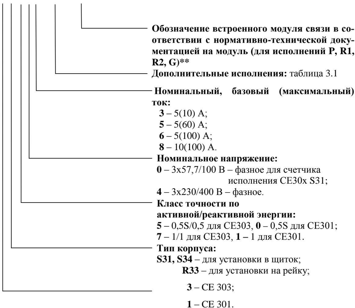
Рисунок 3.1 – Структура условного обозначения
