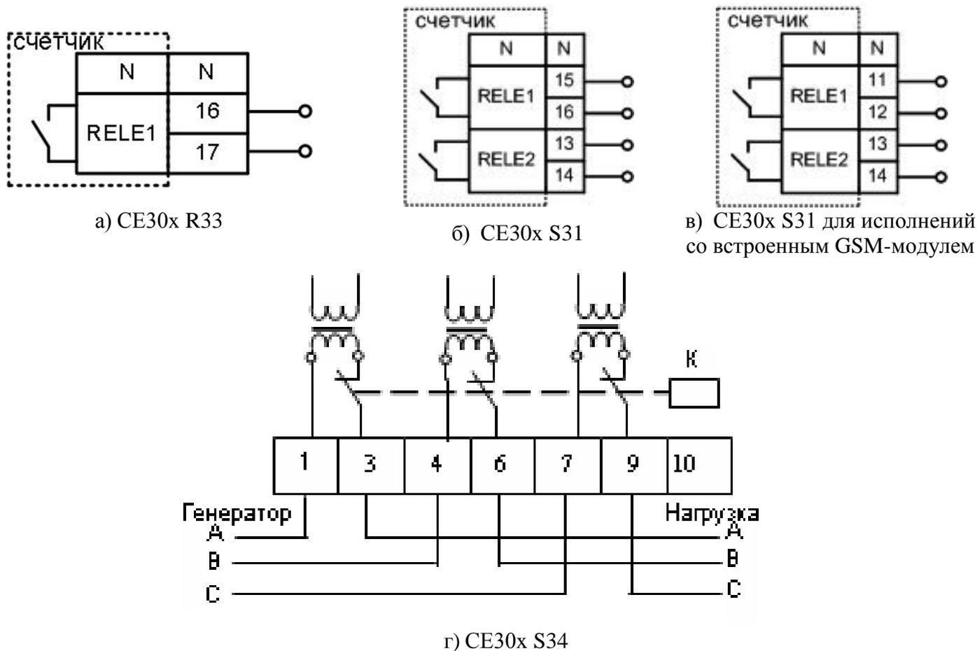
Рисунок 5.5 – Схемы подключения реле
