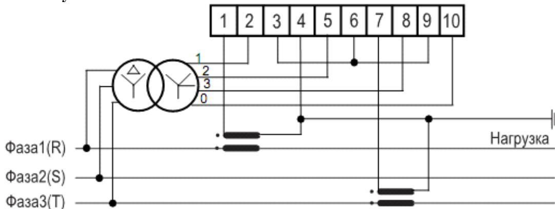
г) Схема включения счетчика СЕ30х S31 57,7 В 5(10)А
