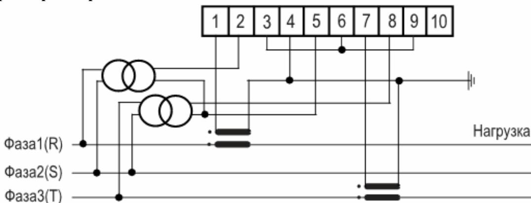
д) Схема включения счетчика СЕ30Х S31 57,7 В 5(10)А
