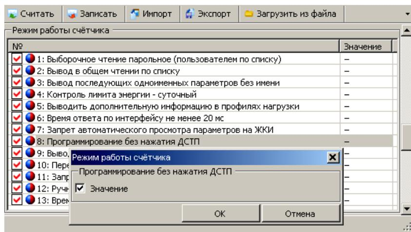
Рисунок 7.27 – Разрешение программирования без нажатия кнопки «ДСТП»
