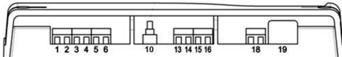
а) обозначение контактов счетчика СЕ30х S3х
