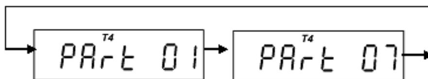
Рисунок 5.14 – Переключение между группами параметров счетчика
