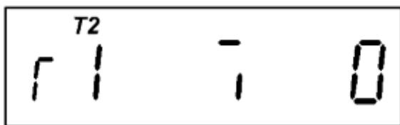
На рисунке 4.15 показано состояние реле 1 – разомкнутое, код критерия управления реле – 0, на данный момент действующий тариф – второй.
