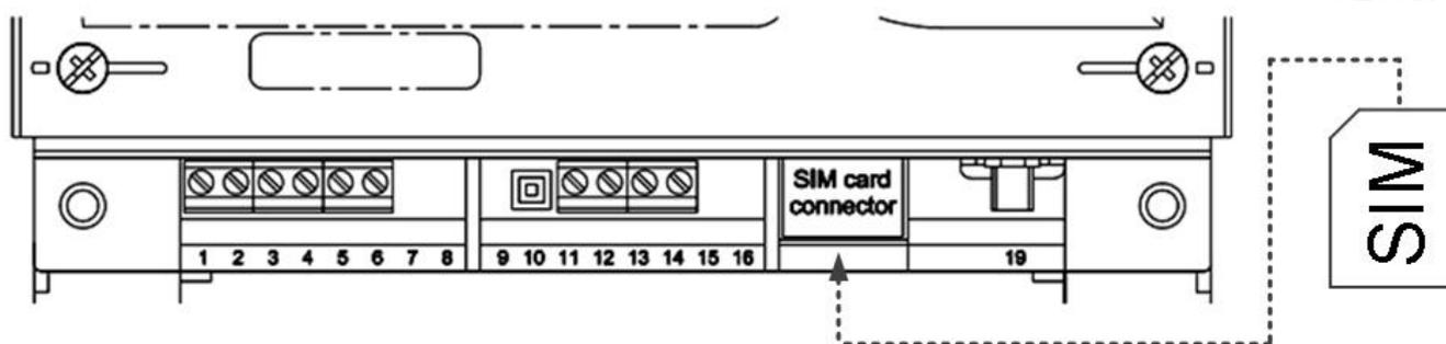
в) обозначение контактов счетчика СЕ30х S3х для исполнений со встроенным GSM-модулем
