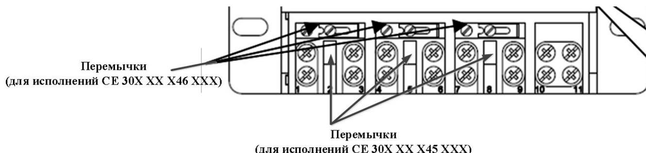
е) расположение перемычек цепей напряжения на колодке счетчика (для счетчиков СЕ 30Х S34 см. рисунок 5.2 е)
