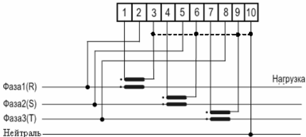
а) Схема включения счетчика СЕ30х 230В 5(10)А
