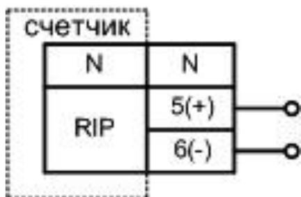
$U_{пит}=9-24$  В,  $I_{пит}=800-300$  мА (в зависимости от  $U_{пит}$ ) – для исполнений счетчика со встроенным GSM-модулем.
