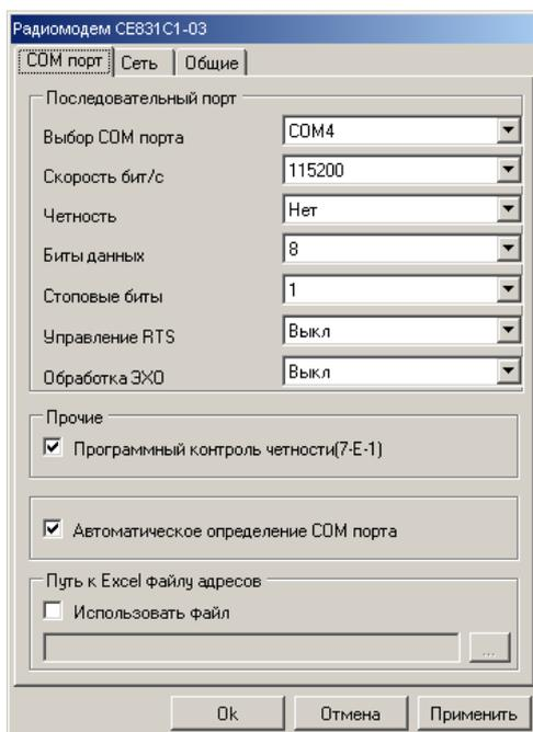
Рисунок 6.7 – Окно редактирования настроек канала связи «CE831C1-03 (CE30x)»
