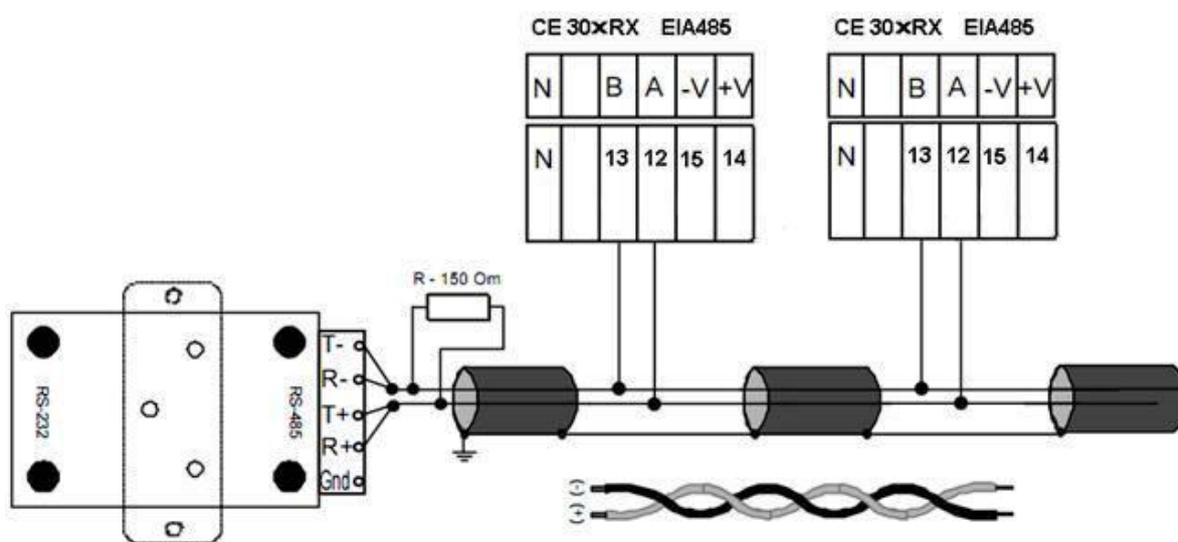
Рисунок 5.6 – Схема подключения счетчика CE30x R33 с интерфейсом EIA485 через внешний адаптер EIA485/EIA232 к COM-порту ПЭВМ
