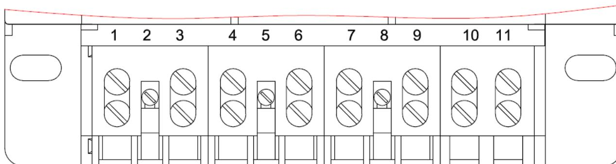
д) – обозначение контактов зажимов счетчика CE303 S31 74X и CE 301 S31 14X
