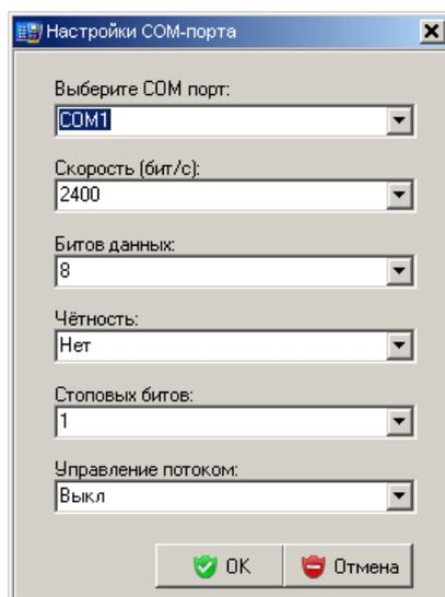
Рисунок 5.21 – Настройки порта связи PLC-модема CE832C
