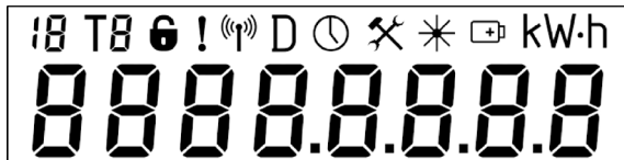
Рисунок 7.1 – Общий вид ЖКИ счетчика в режиме теста
